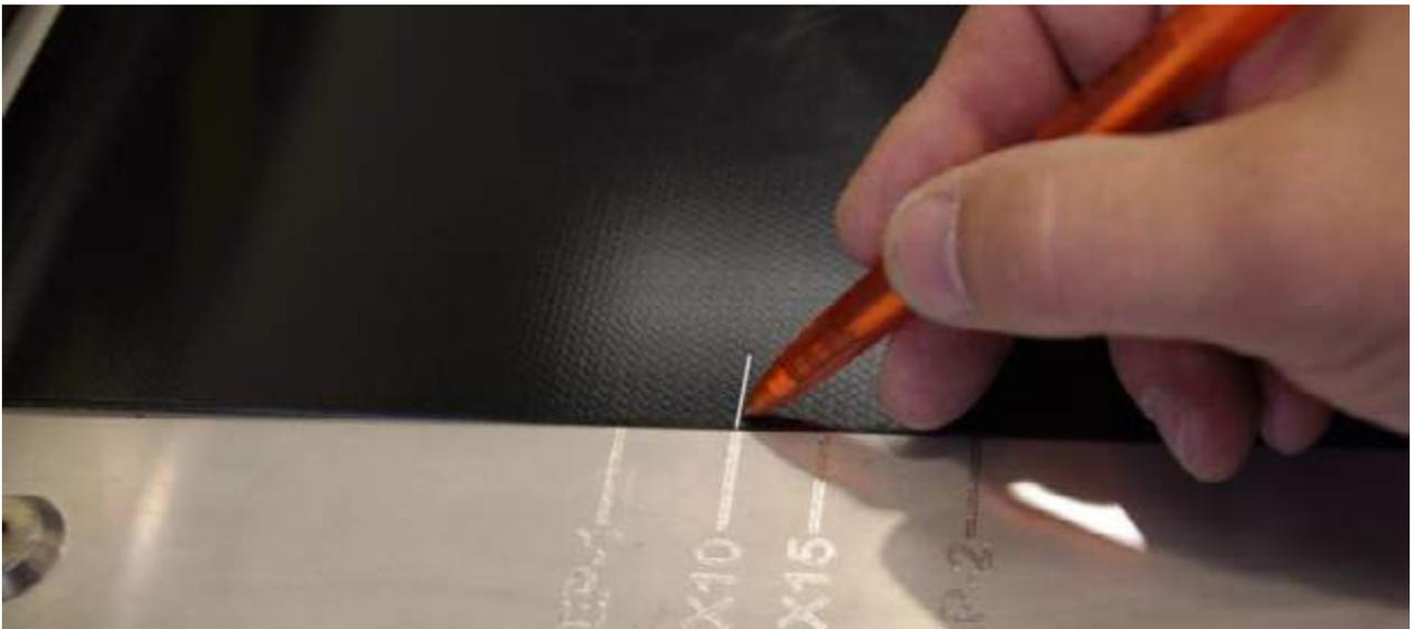
Placer ensuite la bande sous la barre de roulement jusqu'à ce que la marque soit en face du 0 et s'assurer qu'elle soit entièrement en contact avec le rail de guidage.
