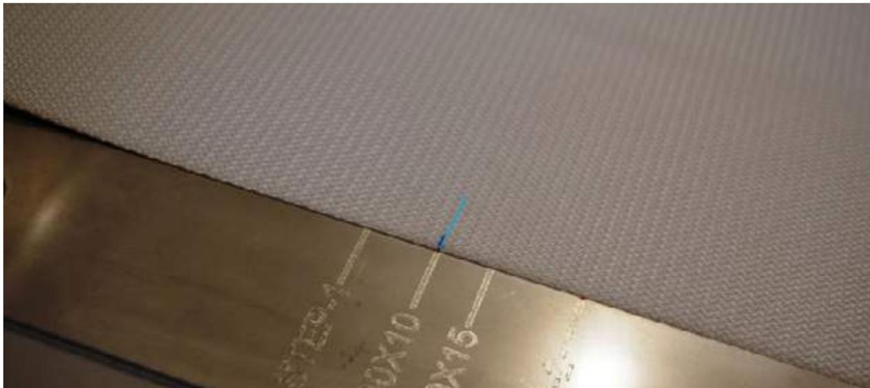
Placer ensuite la bande sous la barre de maintien jusqu'à ce que la marque soit en face du 0 et s'assurer qu'elle soit entièrement en contact avec le rail de guidage.
