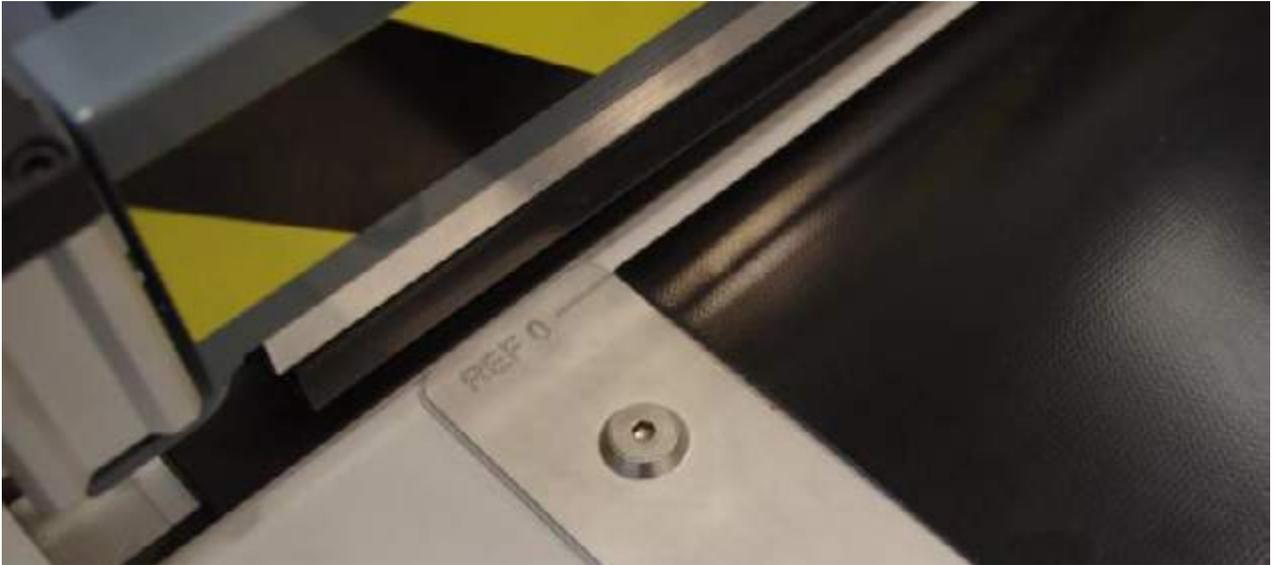
Marquer ensuite un repère au crayon afin de n'utiliser que le morceau de bande nécessaire, en fonction de la lame que l'on souhaite utiliser.
