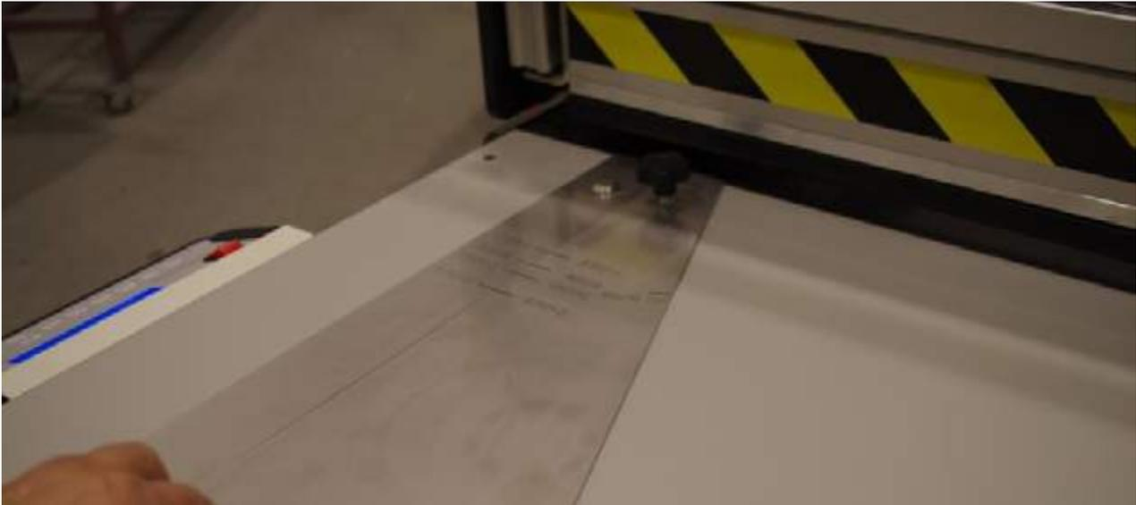
Placer la bande déjà coupée en diagonale à 70° avec le guide supplémentaire pour marquer de 0 Réf. la mesure d'avance de 80x10 à 70°.
