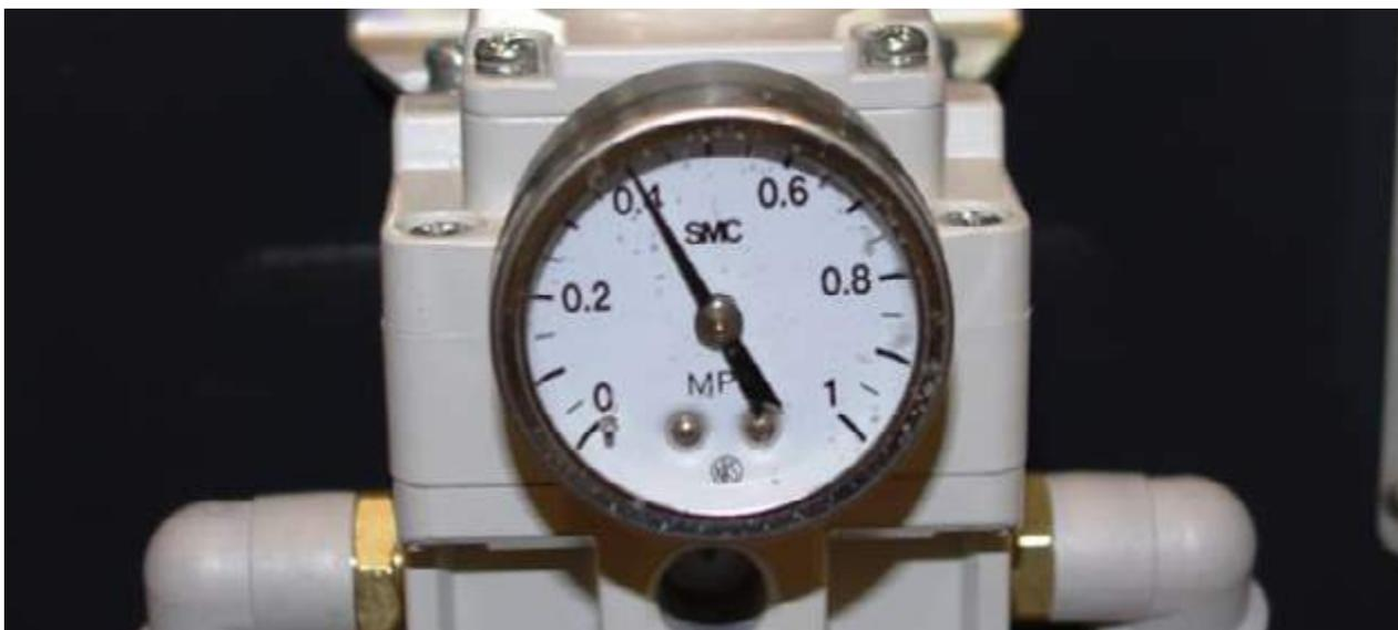
Ce dispositif de réglage subit une perte d'air afin de maintenir la pression exacte de façon constante.
