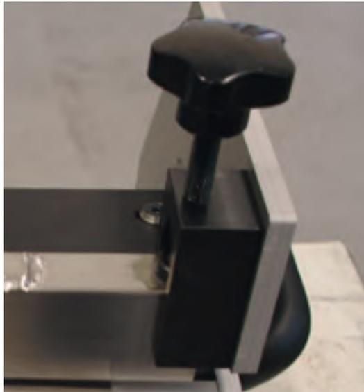
Une fois la bande fixée, appuyez sur le levier de dégagement et déplacez la tête jusqu'en butée sur le côté gauche (Point vert).
