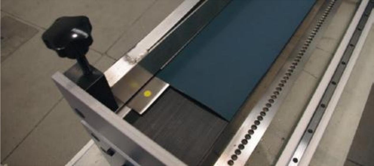
Fixez à nouveau la bande avec la barre de serrage et déverrouillez la tête, déplacez-la jusqu'au bout de la bande sans la découper :
