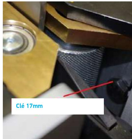
Pour régler la hauteur du rouleau inférieur, ajustez la vis M8 qui se trouve sur le capot latéral droit, à côté de la commande permettant le réglage de la hauteur.
