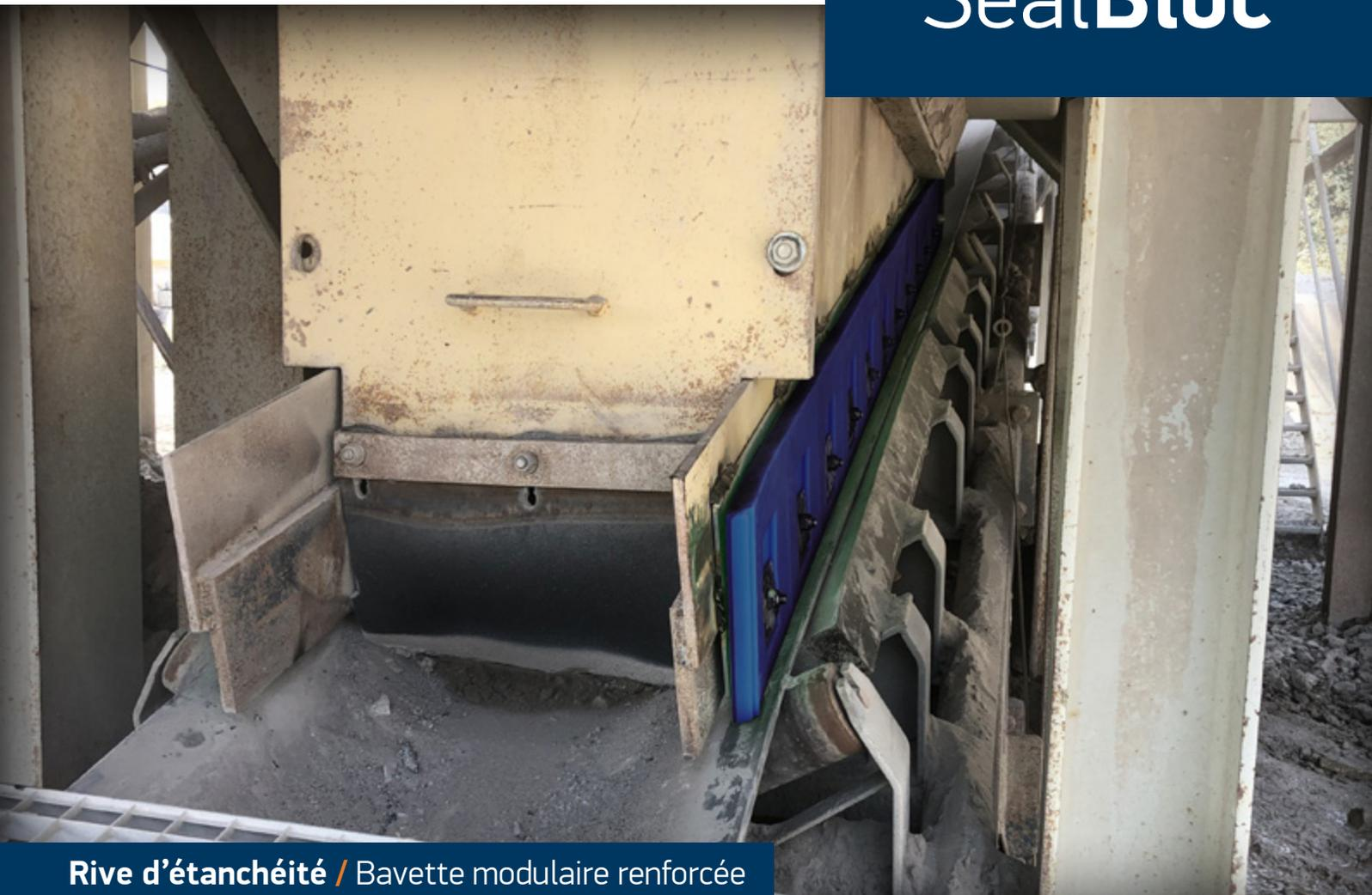
**Rive d'étanchéité /** Bavette modulaire renforcée
