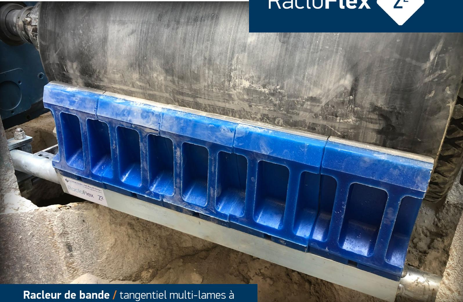
**Racleur de bande /** tangentiel multi-lames à compensation automatique par ressort
