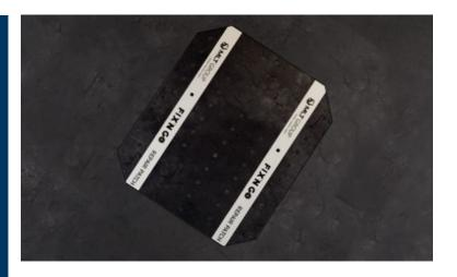
Pour vos bandes transporteuses caoutchouc à carcasse métallique ou textile de forte tension, la jonction souple à visser **SUPER-SCREW®\*** peut-être aussi idéale en patch de réparation (trous ou déchirures dans votre bande). Auto-foreuses et auto-taraudeuses, les vis pincent les câbles ou passent à travers en apportant une nouvelle résistance à la carcasse de la bande.
